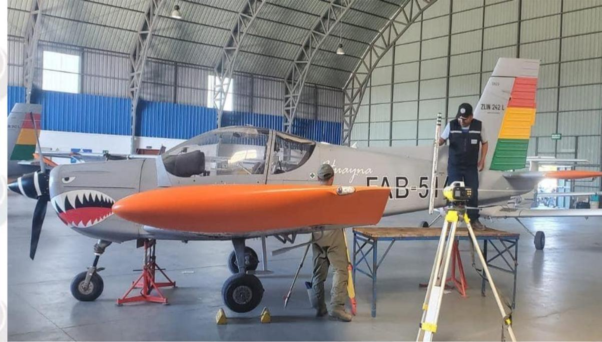
APOYO EN LA INSPECCIÓN DE 500 HRS. DE 03 AERONAVES ZLIN Z-242L DEL GAE “21”, APLICANDO LA MEDICIÓN DE SIMETRÍA Y CONICIDAD MEDIANTE NIVELACIÓN GEOMETRICA.
